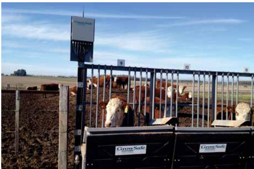
Los animales están identificados con caravanas electrónicas, se observa el receptor/transmisor de los datos a la PC del sistema.
